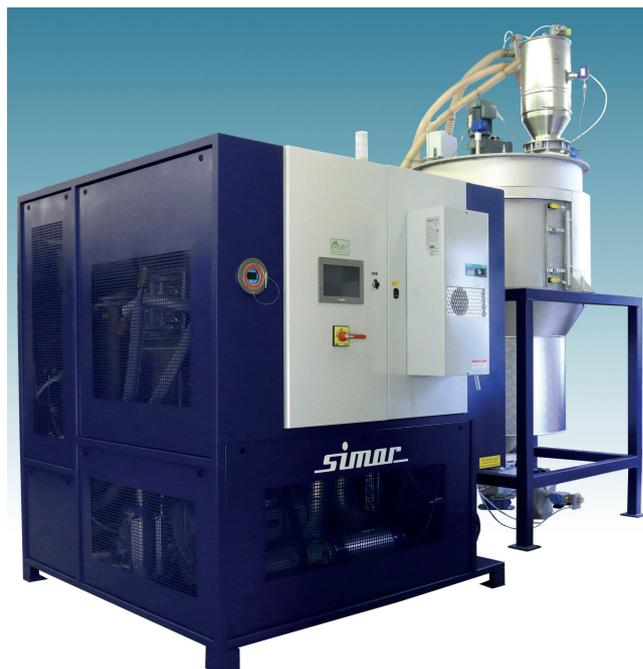
**Bild 1.** Im eVOC-Entgasungstrockner schlägt sich die VOC-beladene Luft als Kondensat nieder und kann separiert werden. © Rembe
